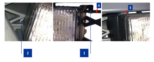
Den linken Befestigungshaken (Pos. 2) des Halters zur Fahrzeugaußenseite in den Kühlergrill einhängen, die obere Rastnase (Pos. 3) in den Kühlergrill (4) einhängen. Dann den Frontblitzer auf der Fahrzeugaußenseite hinter die Rippe (5) einrasten.
