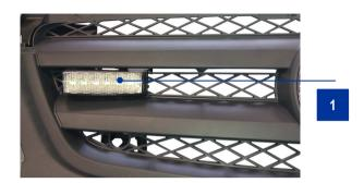
Montageort des LED-Frontblitzes K-FS 4 (Pos. 1) am Beispiel der rechten Fahrzeugfront eines Mercedes Benz Vitos (BFS).
