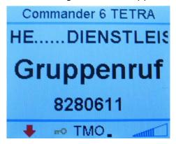
Um selbst einen Gruppenruf zu starten, halten Sie die seitlich am Hörer befindliche PTT-Taste gedrückt. Nach dem Signalton (hörbar über die Hörkapsel) können Sie sprechen. Die erhaltene TX-Erlaubnis wird außerdem im Display durch den grünen PTT-Pfeil signalisiert.
