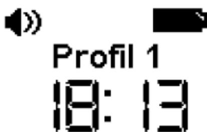
zustand an. Die Statuszeile zeigt auch das Vorhandensein ungelesener Meldungen und allfällige Feldstärkealarme an. In der mittleren Zeile wird der Profilname angezeigt. Wird das Gerät geladen, so wird der Profilname durch das Ladeprofil ergänzt. Auf der untersten Zeile schliesslich wird die Uhrzeit angezeigt. Folgende Symbole können in der Statuszeile angezeigt werden:
